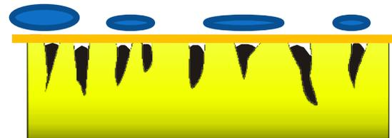
Une infime couche de graisse accumulée suffit à empêcher le contact du Surefoot avec l'eau, empêchant la réaction.
